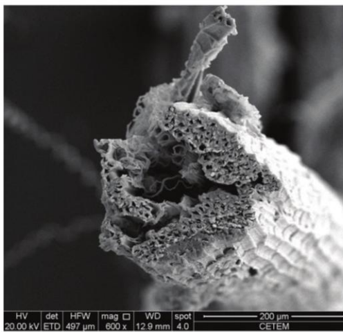
Сизалевое волокно под сканирующим микроскопом
