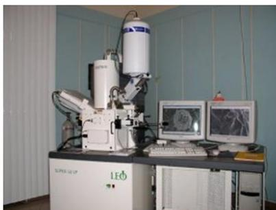
Б. Сканирующий электронный микроскоп
