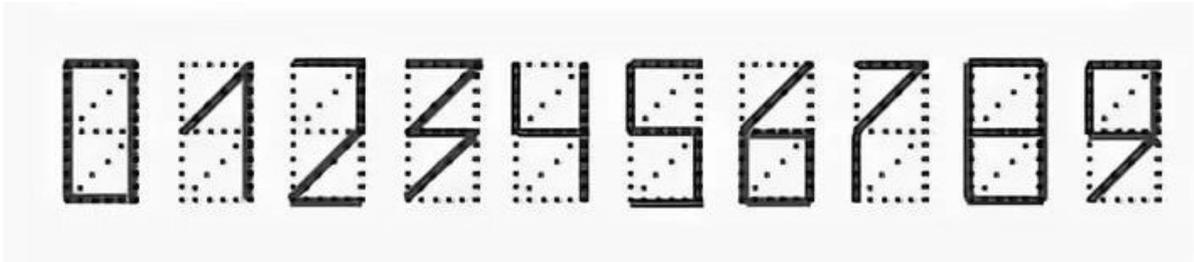
После неудачного эксперимента индикатор повредился, и часть сегментов могла перегореть. Когда сегмент перегорает, индикатор теряет возможность показывать цифры, использующие этот сегмент.
