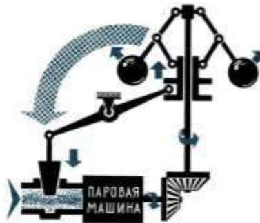
Рис.2 – Схема работы центробежного регулятора Уатта
