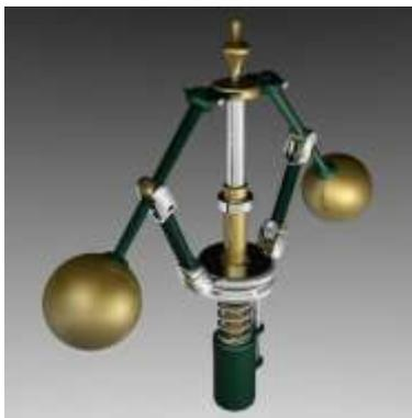
Рис.1 – Визуализация центробежного механизма регулятора Уатта
