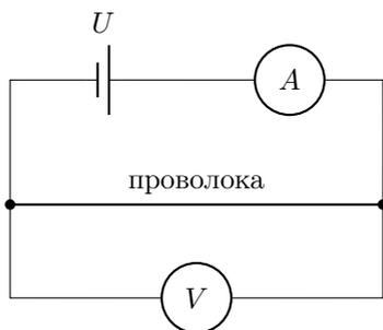
Подключим кусок проволоки, амперметр и источник последовательно. Параллельно с куском проволоки подключим мультиметр в режиме вольтметра.
