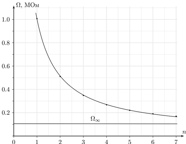
При  $r = 0$  наша цепь превращается в  $n$  параллельно соединенных резисторов  $R$
