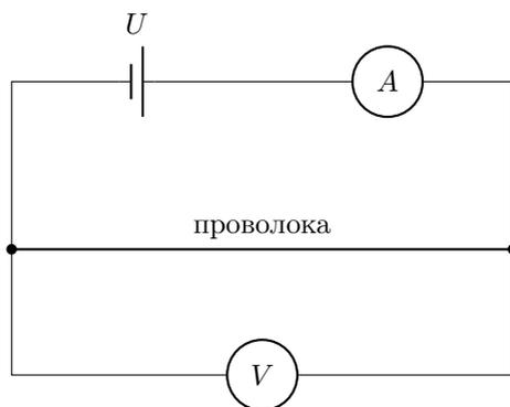
Выданная проволока неизолированная, так что при помещении её в воду важно, чтобы не было касания (т.е. электрического контакта) друг с другом витков проволоки. Если допустить контакты между витками проволоки, то они могут смещаться при налипании воды, меняя сопротивление проволоки.
