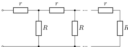
1. Определите сопротивления всех резисторов и проверьте, что все резисторы  $r$  и все резисторы  $R$  ( $r \ll R$ ) имеют одинаковые сопротивления в пределах точности измерений мультиметра. Считайте погрешность мультиметра в этом и последующих пунктах равной трём единицам последнего разряда. Если есть резисторы  $R$ , сопротивление которых отличается больше, чем на 1%, попросите их заменить. Вычислите средние значения  $R$  и  $r$  и их погрешности.
