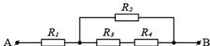
Определите величину общего сопротивления участка АВ ( $R$ ).  $R_1 = 2$  Ом,  $R_2 = 2$  Ом,  $R_3 = 1$  Ом,  $R_4 = 1$  Ом. Ответ выразите в омах.
