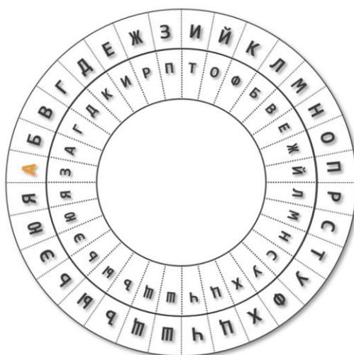
Для зашифрования его устанавливают в какое-то положение, определяемое договорённостью отправителя и получателя. После этого букву открытого текста отыскивают на внешнем диске, а в качестве замены используют соответствующую ей букву на внутреннем диске. После зашифрования каждой буквы внутренний диск поворачивается на одно деление, и зашифрование следующей буквы происходит уже на основе нового положения диска.
