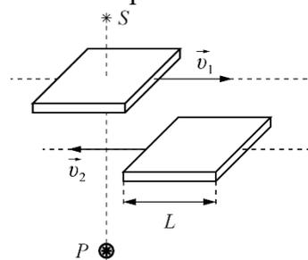
**8.1. Возможное решение.** Жёлтая лампочка загорается на дисплее в момент, когда одна из пластин (будем называть её первой) начинает перекрывать путь сигналу. В момент, когда загорается красная лампочка, на пути сигнала возникает вторая пластина. Красный цвет меняется на жёлтый, когда одна из пластин перестает мешать прохождению сигнала. Причём, это может быть как первая, так и вторая пластина.
