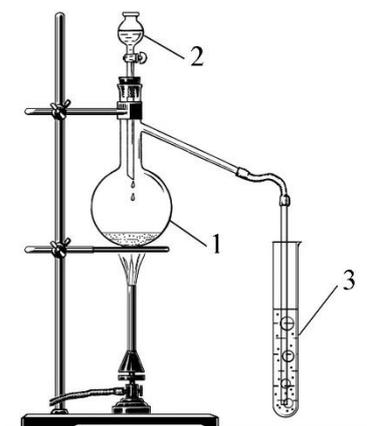
Из капельной воронки (2) добавили концентрированную серную кислоту. При этом из колбы (1) начал выделяться бесцветный газ В с резким запахом. Газ В пропускали в пробирку (3) с бесцветным раствором кислоты С. В результате реакции раствор в пробирке (3) постепенно принимал красную окраску за счёт образования коллоидных частиц простого вещества D.
