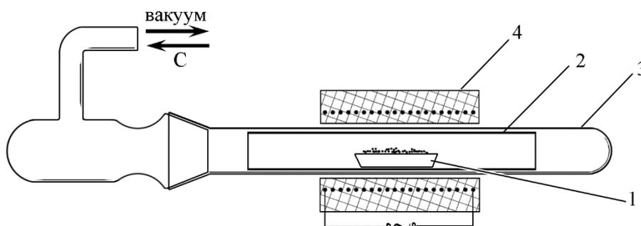
Лодочку (1) вставили в стальную трубку (2), которую поместили в кварцевую трубку (3). Из прибора откачали воздух и сильно нагрели в трубчатой печи (4). Металл **A** испарился из реакционной смеси и сконденсировался на внутренних стенках трубки (2). После остывания прибор заполнили бесцветным газом **C**, а затем снова нагрели. В результате реакции соединения металла **A** с газом **C** образовалось соединение **D** – бесцветные, очень чувствительные к влаге и воздуху кристаллы.
