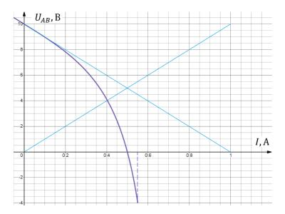
Напряжение на клеммах A и B, при подключении к ним резистора с сопротивлением 10 Ом, найдем графически. Построим ВАХ резистора на графике с нагрузочной кривой. Пересечение графиков даст искомый ответ 4.0 В.
