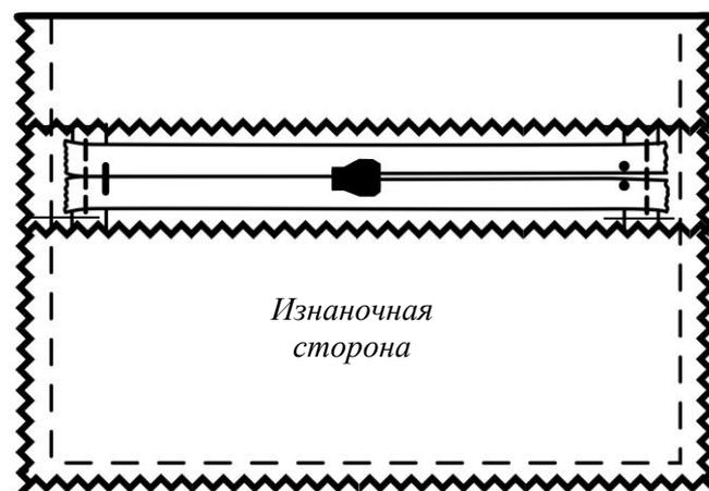
14. Для придания изделию формы сформируйте дно клатча. Тщательно выправьте ткань каждого нижнего угла изделия так, чтобы боковые и нижние швы обтачивания находились один поверх другого. Запас шва обтачивания направьте в сторону задней стенки клатча. Скрепите булавками. Проведите строчку перпендикулярную боковому шву согласно схеме. Строчка формирования дна должна получиться около 40 мм.
