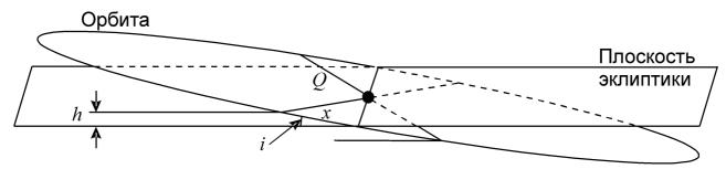
Обозначим угол наклона плоскости орбиты к эклиптике через i, радиус орбиты — через Q. Величина h существенно меньше максимального удаления точки орбиты от плоскости эклиптики Qi (равного 35000 км для Луны и 6.5 млн км для Венеры). Для того, чтобы точка орбиты находилась не далее расстояния h от плоскости эклиптики, она должна быть удалена от узла орбиты не далее, чем на расстояние:
