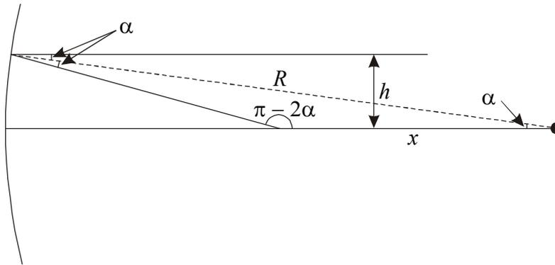
Обратим внимание, что угол между оптической осью зеркала и радиусом в точке касания также равен  $\alpha$ . Воспользуемся теоремой синусов:
